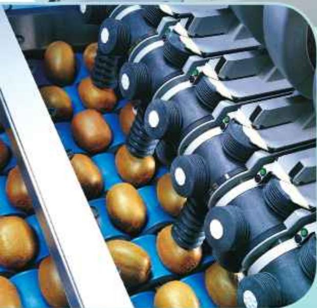
La CR4 à Têtes Multiples Fixes est la solution idéale si vous souhaitez étiqueter individuellement des rangs serrés d'une même variété de fruit lorsque la vitesse de défilement de la ligne est inférieure à 240 fruits par minute et par ligne. La détection des fruits est effectuée par un scanner-barre et la vitesse de réponse des applicateurs varie en fonction des informations transmises par le convoyeur du client au système Sinclair.
