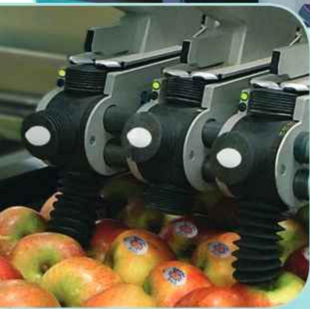
La CR4 à Têtes Multiples Fixes est la solution idéale si vous souhaitez étiqueter individuellement des rangs serrés d'une même variété de fruit lorsque la vitesse de défilement de la ligne est inférieure à 240 fruits par minute et par ligne. La détection des fruits est effectuée par un scanner-barre et la vitesse de réponse des applicateurs varie en fonction des informations transmises par le convoyeur du client au système Sinclair.
